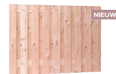
Douglas plankenscherm 19-planks 17 planken, 2 tussenregels. Geschaafd recht verticaal. Planken 1,6x14 cm. 180x130 cm NIEUW 42084 00,00
