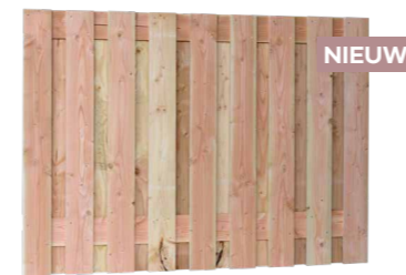
Douglas plankenscherm 19-planks 17 planken, 2 tussenregels. Fijnbezaagd recht verticaal. Planken 1,5x14 cm. 180x130 cm NIEUW 42086 00,00
